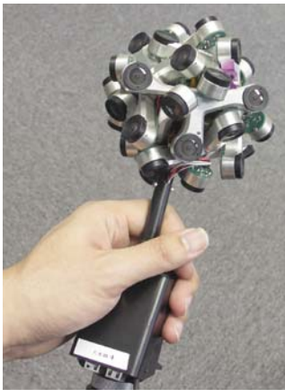
図5 全方位ステレオカメラシステム
