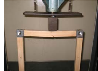
50cm スパン 中央荷重 500kg で破断
