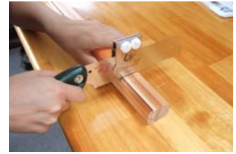
直角にカットする治具（市販工具：ソーガイド）
