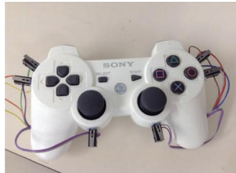
図4 コントローラの改造例
